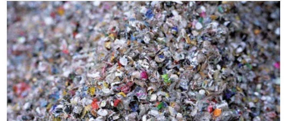
**Sekundärbrennstoffe** sind Brennstoffe, die durch spezielle und anspruchsvolle Aufbereitung aus den Heizwertreichen Fraktionen des Siedlungsabfalls oder aus produktionsspezifischen Abfällen hergestellt werden. Damit eine hochwertige Verwertung sichergestellt ist, müssen Sekundärbrennstoffe einer festgelegten Qualität entsprechen. Sekundärbrennstoffe werden mitverbrannt. Sie ersetzen einen Teil der fossilen Energieträger, z. B. in Kraft-, Zement- und Kalkwerken.
